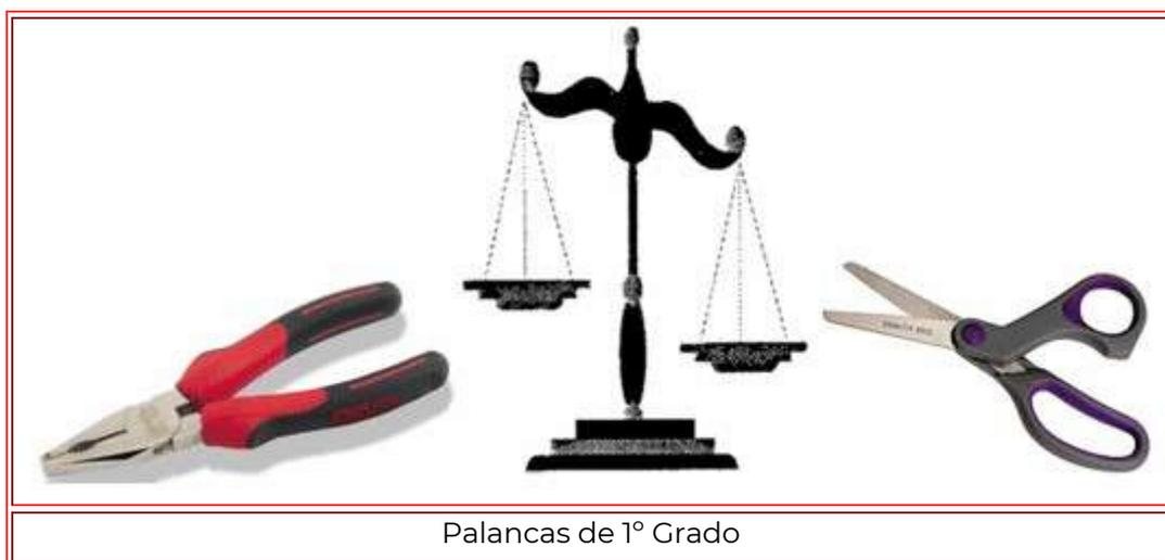
Algo que desde ya debe destacarse es que al accionar una palanca se producirá un movimiento rotatorio respecto al fulcro, que en ese caso sería el eje de rotación.
