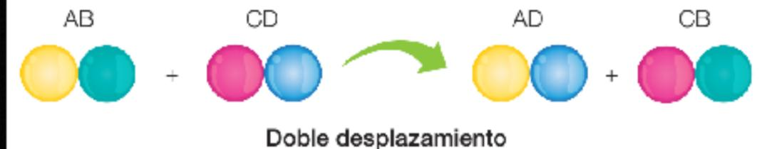
Ejemplos de reacciones de sustitución por doble desplazamiento son las reacciones entre algunas sales y entre hidróxidos y ácidos cuando se encuentran en disolución acuosa. Tal es el caso de la reacción entre el nitrato de plata ( $\text{AgNO}_3$ ) y el cloruro de sodio ( $\text{NaCl}$ ).
