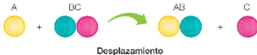
Un ejemplo de reacción de sustitución por desplazamiento simple es la reacción entre algunos metales y la disolución acuosa de ciertos ácidos. Es el caso de la reacción entre el magnesio y ácido clorhídrico, que ya hemos revisado en páginas anteriores.
