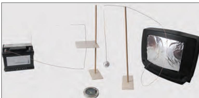
1. Con el papel de aluminio, el alambre de cobre fino y uno de los soportes, construyan el péndulo que se observa en la fotografía.
