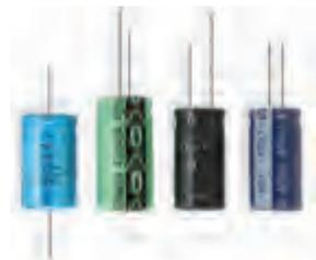
Los condensadores son usados en circuitos electrónicos (computadores, televisores, equipos de video, etc.).
