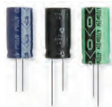
La capacidad de un condensador se refiere a la cantidad de cargas eléctricas que es capaz de almacenar.
