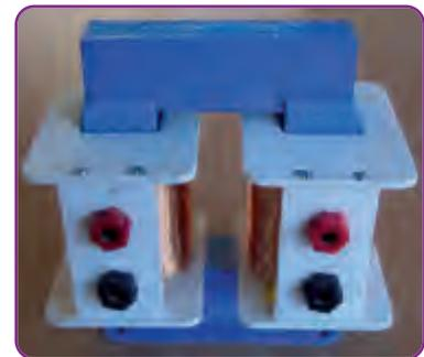
Transformador para laboratorio. En la imagen se pueden observar claramente los devanados y el núcleo de hierro.
