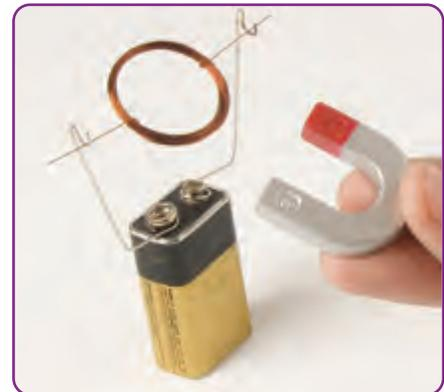
Lo realizado en la *Actividad 11* corresponde a una de las aplicaciones más útiles de la fuerza experimentada por un conductor eléctrico en presencia de un campo magnético perpendicular a él. Esta aplicación es conocida como el **motor eléctrico**, el que transforma energía eléctrica en energía mecánica.
