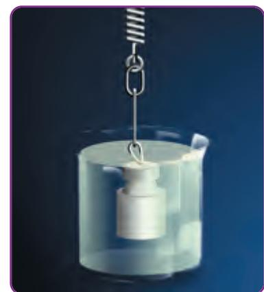
Al igual que las oscilaciones del resorte se detienen por efecto de la resistencia del agua, las oscilaciones en el circuito *RLC* son frenadas por la resistencia eléctrica.
