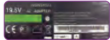
Información de un adaptador para computador. Además del transformador de voltaje, este dispositivo en particular, así como los cargadores de celulares, tienen circuitos que rectifican la corriente de alterna a continua.
