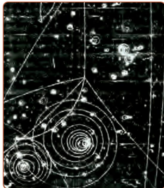
La imagen muestra la trayectoria de partículas subatómicas al interior de una **cámara de burbujas**, luego de una colisión. Muchas veces se realizan bajo la influencia de un campo magnético intenso para determinar si tienen propiedades eléctricas.
